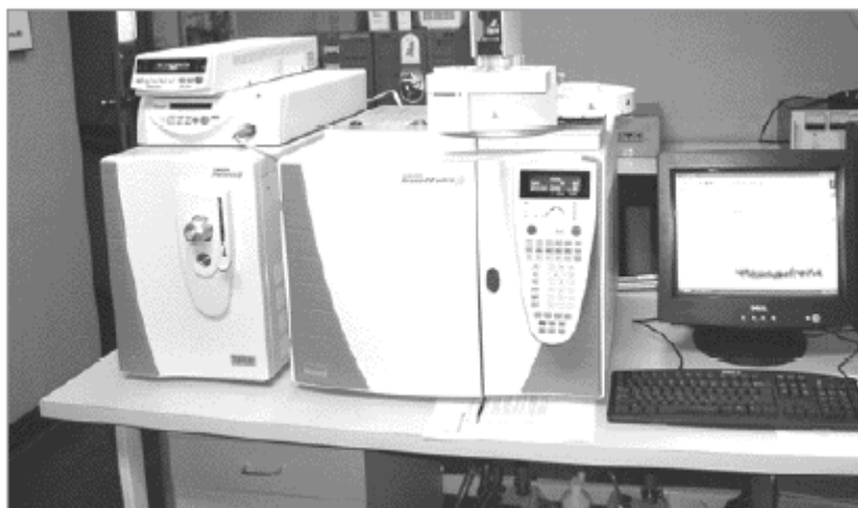
รูปที่ 1 เครื่องแก๊สโครมาโทกราฟี - แมสสเปกโตรเมตรี
