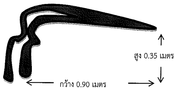
ภาพที่ 2 ส่วนประกอบและขนาดของสันกำเนิดเงา
